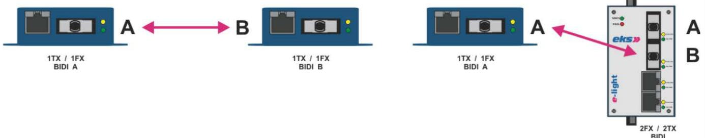
Bei Verwendung von Systemen mit optischem BIDI-Anschluss müssen immer die optischen Anschlüsse (Transceiver) vom Typ A mit Typ B verbunden werden (siehe dazu der Hinweis auf dem rückseitigen Typenschild).
