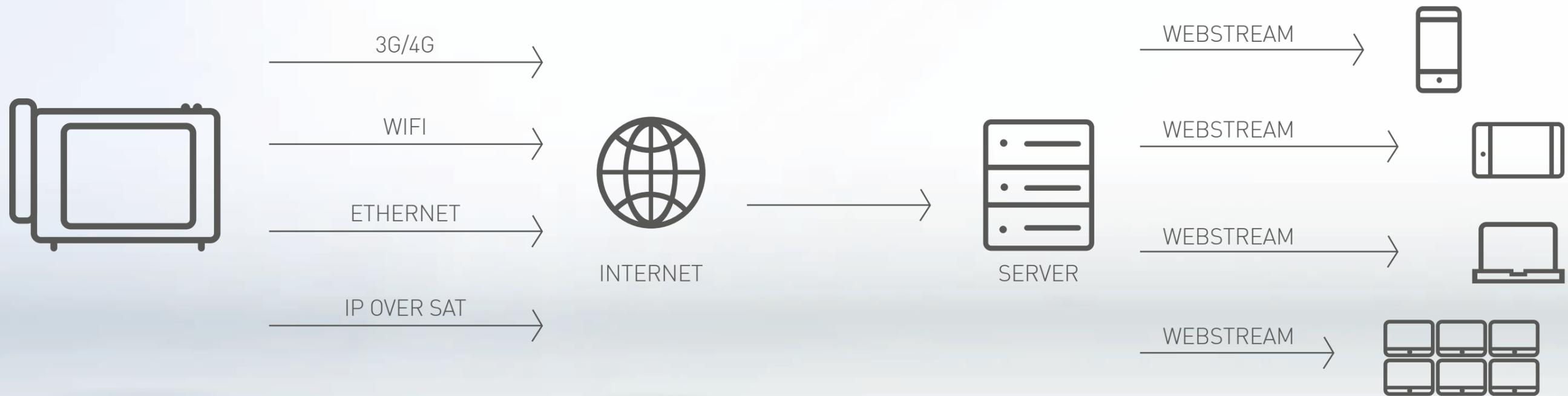
Zu den Kernelementen der S-LIVE-Technologie zählt das intelligente Datenhandling. Industrial Livestreaming mit hochauflösender Videoqualität erfordert den sicheren Transport großer Datenvolumina – eine Anforderung, die je nach Einsatzbereich nicht in jedem Fall mit WLAN- oder LAN-Verbindungen zu realisieren ist. Deswegen bündelt S-LIVE mehrere Internetleitungen miteinander.
